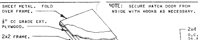
HATCH DOOR DETAIL
